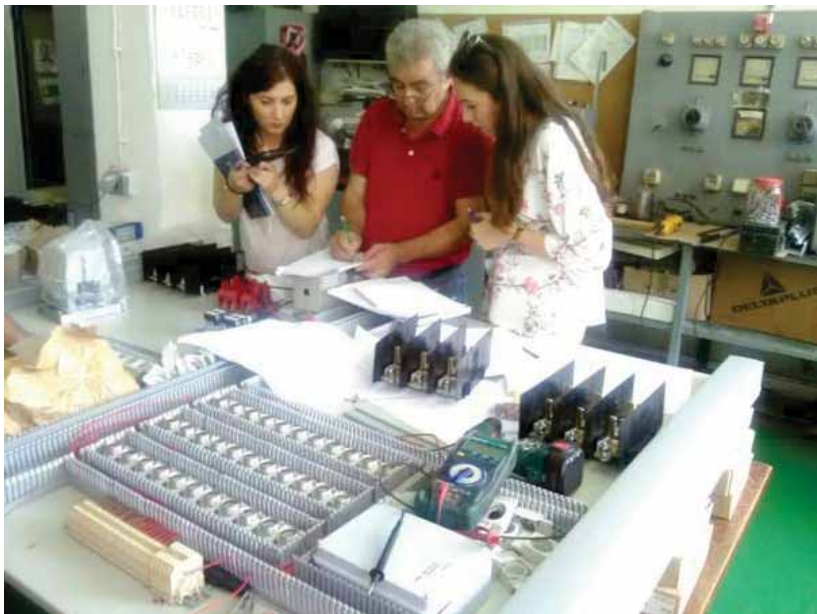
Izrada ormara za električnu energiju u radionici Toplana – 20.07.2018.
